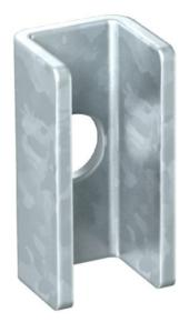
Para la estática razones, el espaciador siempre se utiliza para prevenir el perfil deformantes cuando la fijación de los tornillos están apretados.
